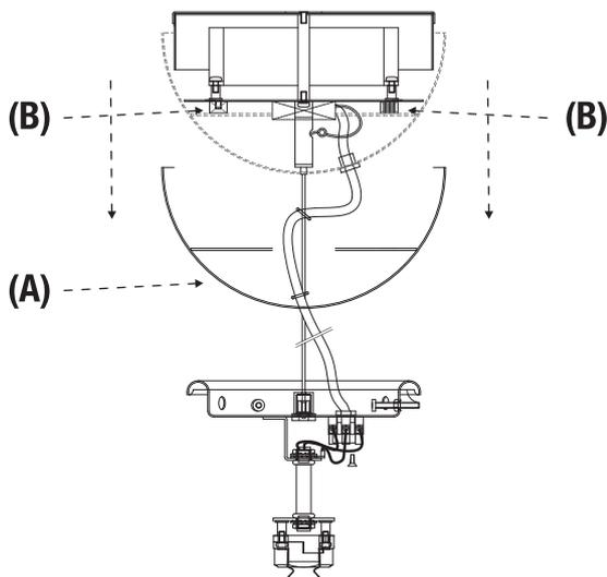
**2** Passare i cavi di rete (C) nel foro (D) della montatura ed inserire le guaine.
